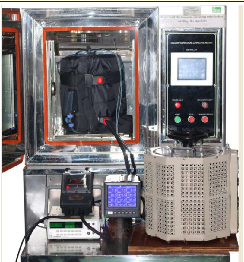
布袋加热器正在负温度进行的气候测试
