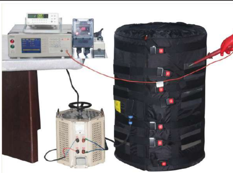
在热条件下总电流泄漏的测量设备
