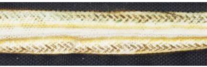
发热电缆在 245^{\circ}C 持续 5 分钟：PA66 已经熔化，并展现了 PTFE 的保护层，其没有变差。发热线的保护经常是通过 PTFE 和硅胶绝缘来完成的。
