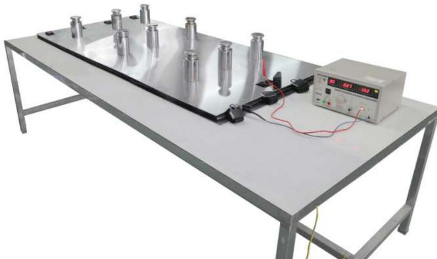
冷态下总电流泄漏的测量设备
